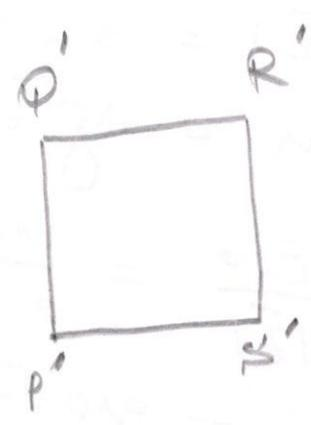
P'Q'R'S' : Si I  $\downarrow$ ,  $\|\vec{B}\| \downarrow$  donc un courant  $i$  circulera dans le cadre P'Q'R'S' de façon à opposer à cette diminution.
